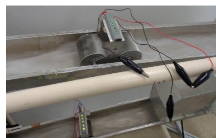
下掛け水車模型で発電実験
