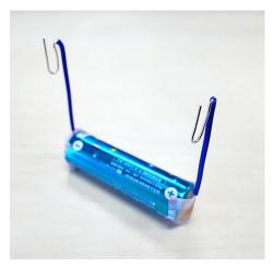
5. 乾電池の荷端に支柱を立て、 テープで留めます
