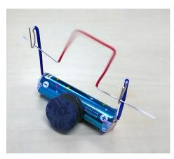
6. 磁石を設置し、回転子を橋渡し するように乗せると回り始めます
