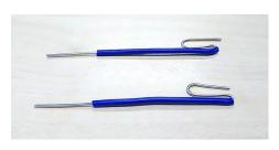
3. 支柱前の電線は図のように折り曲げます
